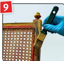
9 Die grundierte, getrocknete und entstaubte Fläche nochmals mit ca. 20 % verdünntem Holz-Siegel lackieren.
