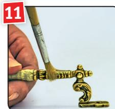
11 Zum Schutz vor Verfärbungen CLOU Zaponlack mit einem Pinsel dünn auftragen und 2 Std. trocknen lassen.
