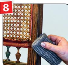
8 Nach Trocknung über Nacht, den Stuhl mit CLOU Stahlwolle 000 leicht anschleifen und entstauben.
