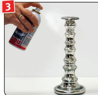
**3** Zaponlack im Abstand von mind. 20–25 cm dünn und gleichmäßig auf das Objekt sprühen und über Nacht trocknen lassen.
