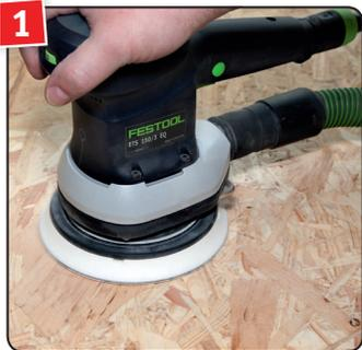
1 Die Oberfläche muss frei sein von Schmutz-, Wachs-, Öl- und Fettresten. Die Fläche in Holzstrukturrichtung mit Körnung 150–180 abschleifen und entstauben.
