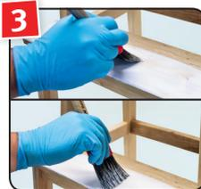
3 Beize mit CLOU Beizpinsel längs, quer und nochmals in Längsrichtung auftragen.
