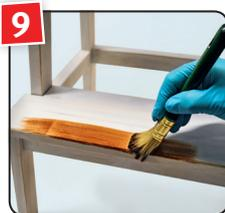
9 Hartöl im Farbton Rotbraun dünn und gleichmäßig mit einem Pinsel auf den bereits geölten Hocker auftragen.
