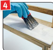
4 Nach 1–2 Min. überschüssige Beize mit einem sauberen Pinsel verteilen, um ein gleichmäßiges Farbergebnis zu erzielen.
