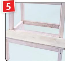
5 Beize über Nacht durchtrocknen lassen. Die Trocknung kann durch Luftbewegung und Temperaturerhöhung verkürzt werden.
