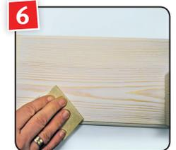
6 Nach 1 Std. Trocknung, Fläche mit Körnung 240 leicht in Holzstrukturrichtung anschleifen und entstauben.
