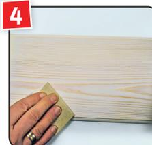
4 Nach Trocknung über Nacht, Fläche mit Körnung 240 anschleifen, um die Jahresringe des Holzes hervorzuholen.
