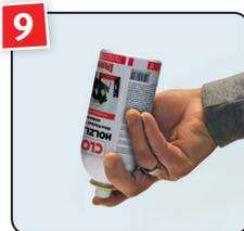
9 Zur Reinigung des Ventils die Sprühdose nach Gebrauch auf den Kopf stellen und den Sprühkopf drücken bis reines Treibgas austritt.
