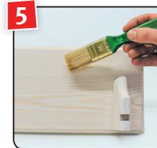
5 Als Grundierung CLOU Schnellschleif-Grundierung mit einem Pinsel auftragen.
