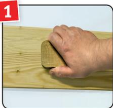
1 Um die Struktur des Holzes hervorzuholen, die Oberfläche mit einer Messingdrahtbürste in Holzstrukturrichtung bürsten und entstauben.
