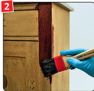
**2** AQUA CLOU Holzbeize im Farbton Mahagoni vor Gebrauch gut aufschütteln und mit dem CLOU Beizpinsel längs, quer und nochmals in Längsrichtung auftragen. Die Fläche über Nacht gut trocknen lassen.
