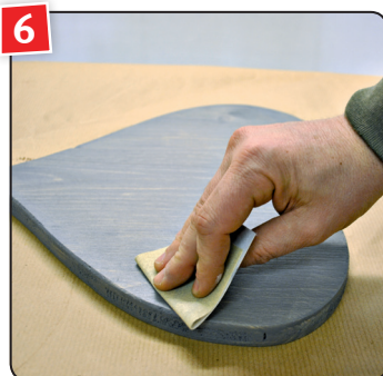
6 Mit Körnung 280–320 anschleifen und Schleifstaub gründlich entfernen.
