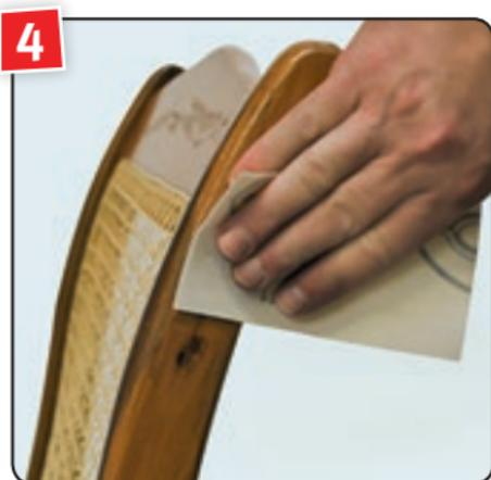
**4** Nach 2–3 Std. Trocknung die Holzpaste-Überreste mit Körnung 240 zum gleichen Niveau der Holzoberfläche planschleifen ...
