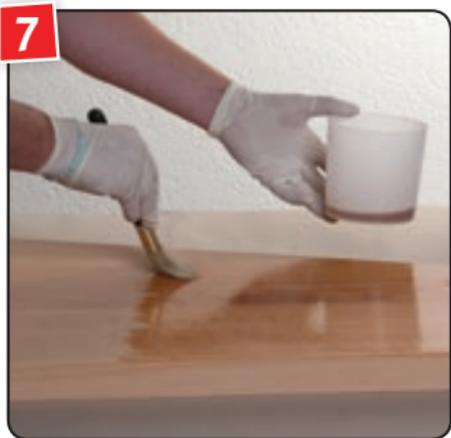
Den zweiten Auftrag mit CLOU Hartöl nach ausreichender Trocknung über Nacht mit Zwischenschliff Körnung 240/280 durchführen.
