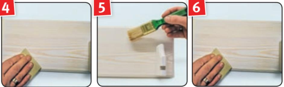
4 Nach Trocknung über Nacht, Fläche mit Körnung 240 anschleifen, um die Jahresringe des Holzes hervorzuheben.
