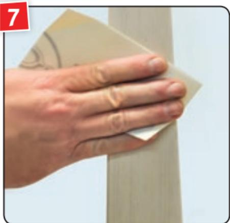
Fläche 3–4 Std. trocknen lassen, mit Körnung 240 zwischenschleifen, entstauben und die Wachslasur nochmals auftragen.
