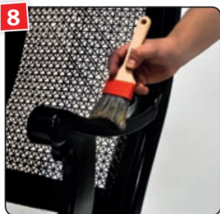
**8** CLOU Holz-Siegel zu 20% mit CLOU EV-Verdünnung mischen und lackieren. Wenn nötig, Auftrag nach Trocknung über Nacht und Zwischenschleiff mit CLOU Stahlwolle 000 wiederholen.
