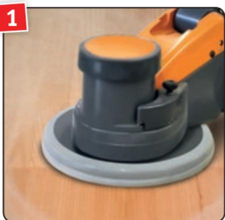
Endschliff der rohen Oberfläche in Holzstrukturrichtung mit einem Schleifgitter und Körnung 120 durchführen.
