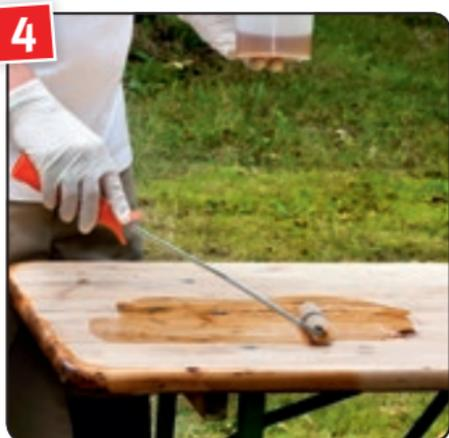
Fläche mit verdünntem Holz-Siegel in Holzstrukturrichtung gleichmäßig grundieren.
