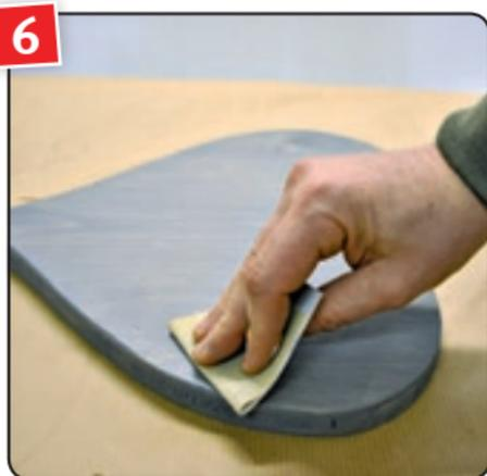
**6** Mit Körnung 280–320 anschleifen und Schleifstaub gründlich entfernen.
