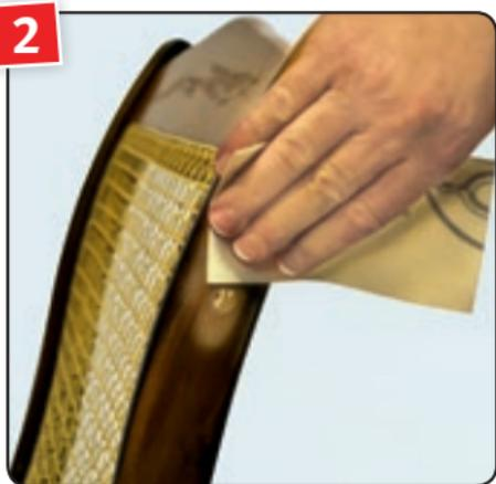
**2** Zur Ausbesserung von Löchern, Schrammen, Rissen oder Fugen im Holz die Unebenheit mit Körnung 180–240 leicht anschleifen und entstauben.
