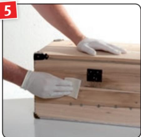
5 Die Fläche mit Körnung 240 leicht anschleifen, entstauben und den Auftrag mit CLOU Naturwachs wiederholen.
