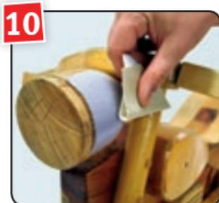
Nach 2–3 Std. Trocknung das Möbelstück mit Körnung 240 anschleifen, entstauben, die Lack-Lasur nochmals auftragen und über Nacht trocknen lassen.
