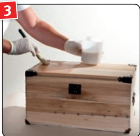
... und als Grundierung mit einem Pinsel dünn in Holzstrukturrichtung auftragen.
