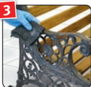
CLOU Lack-Abbeizer unverdünnt mit Pinsel oder Spachtel mind. 1 mm dick auftragen. Beim Verarbeiten Schutzbrille, Handschuhe tragen und für gute Belüftung sorgen oder im Freien arbeiten.
