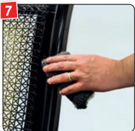
**7** Über Nacht trocknen lassen für strapazierfähige Oberflächen Möbelstück mit CLOU Stahlwolle 000 nochmals leicht anschleifen und entstauben.
