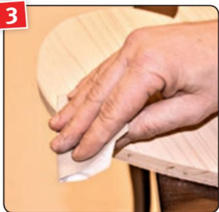
Für eine glatte Oberfläche Holzherz mit Körnung 280–320 anschleifen und Schleifstaub entfernen.
