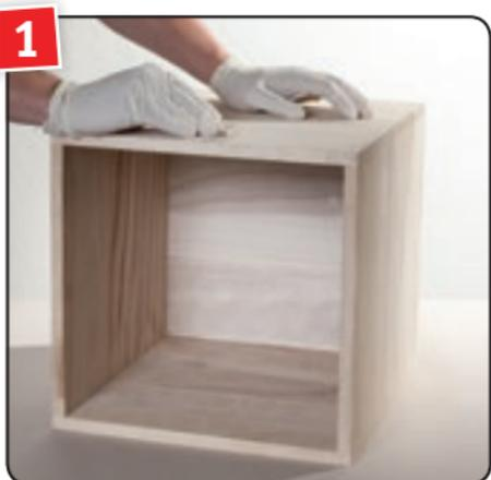
**1** Rohe Fläche in Richtung der Holzstruktur mit Körnung 280 anschleifen und entstauben.
