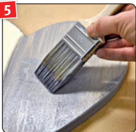
**5** AQUA COMBI-CLOU Lack-Lasur im Farbton Steingrau großzügig auftragen und ca. 3 Stunden trocknen lassen.
