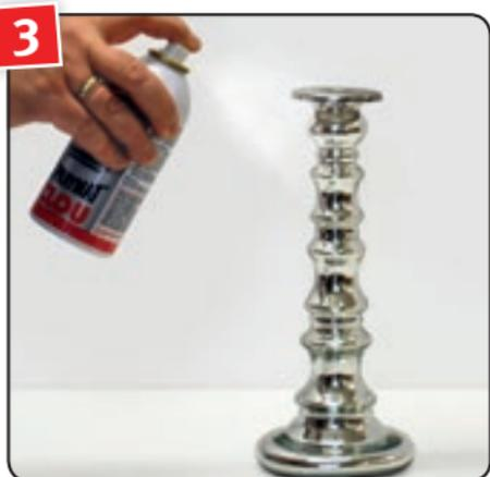
Zaponlack im Abstand von mind. 20–25 cm dünn und gleichmäßig auf das Objekt sprühen und über Nacht trocknen lassen.
