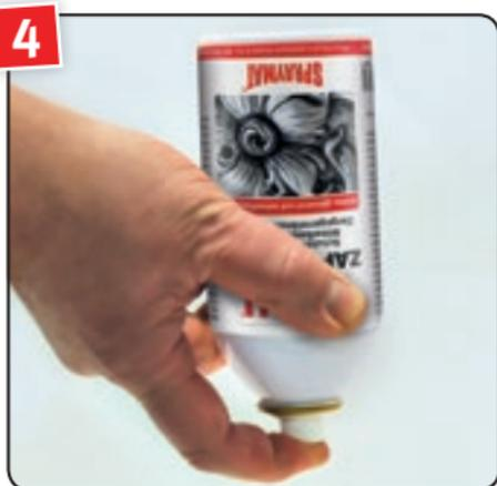
Zur Reinigung des Ventils die Sprühdose nach Gebrauch auf den Kopf stellen und den Sprühkopf drücken bis reines Treibgas austritt.
