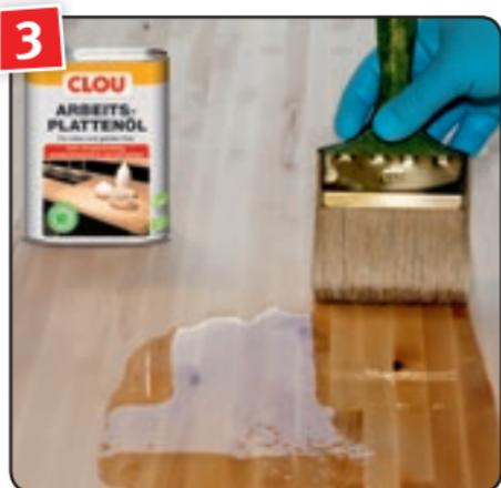
Das Öl mit einem Pinsel oder Öl-Roller gleichmäßig satt in Holzstrukturrichtung auftragen und ca. 30 Minuten einziehen lassen.
