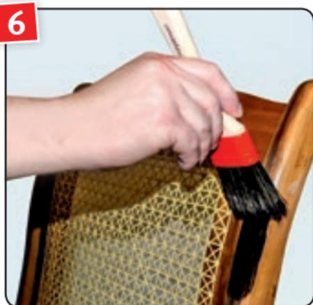
**6** CLOU Möbel-Lasur-Lack im Farbton Nussbaum dunkel unverdünnt, nicht zu satt auftragen und 1 Std. trocknen lassen. Auftrag nach Zwischenschliff mit CLOU Stahlwolle 000 wiederholen.
