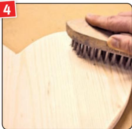
Um die Holzstruktur hervorzuheben, das Holz mit einer Messingdrahtbürste in Strukturrichtung bürsten und gründlich entstauben.
