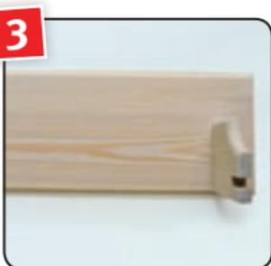
Um die Struktur des Holzes hervorzuheben, die Oberfläche mit einer Messingdrahtbürste in Holzstrukturrichtung bürsten und entstauben.
