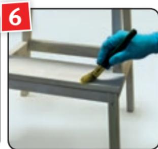
Nach 1–2 Min. überschüssige Beize mit einem sauberen Pinsel verteilen, um ein gleichmäßiges Farbergebnis zu erzielen.
