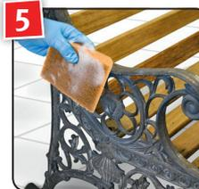
**5** Die abgebeizte Fläche gründlich mit Wasser und einem Schwamm reinigen und vor der weiteren Verarbeitung mit Metalllacken gut trocknen lassen.
