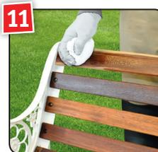
**11** Das überschüssige Öl nach 10 min. mit einem sauberen Baumwolltuch abnehmen. Nach Trocknung über Nacht und einem Zwischenschliff den Auftrag mit einem Schleifvlies wiederholen.
